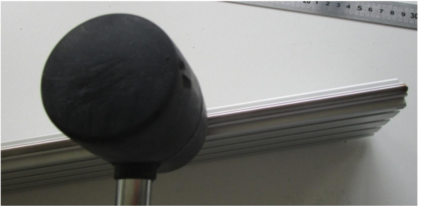
Une fois fait, la barre lisse  $\varnothing$  6mm doit être parfaitement clipsée sur toute sa longueur dans le clip aluminium lui-même engagé dans la rainure du profilé :
