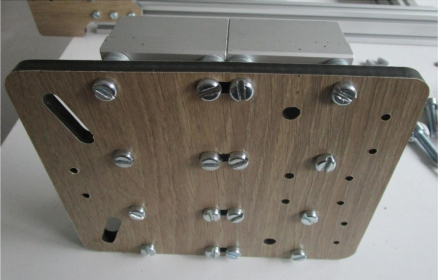
Note : les 2 vis internes seront à dévisser à nouveau ultérieurement pour mettre en place l'écrou de tige fileté d'entraînement du Z.
