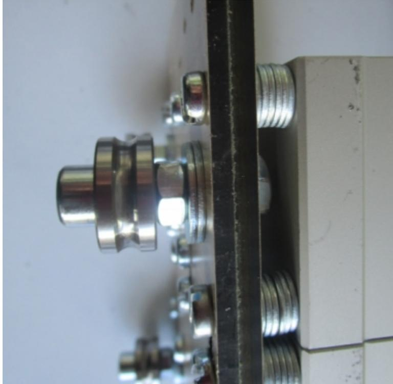
Ensuite, fixer les 2 autres roulements à billes en U dans les trous ovales avec vis M8 x 35 + écrou + **2 rondelles M8 grande** + rondelle M8 grande + écrou :
