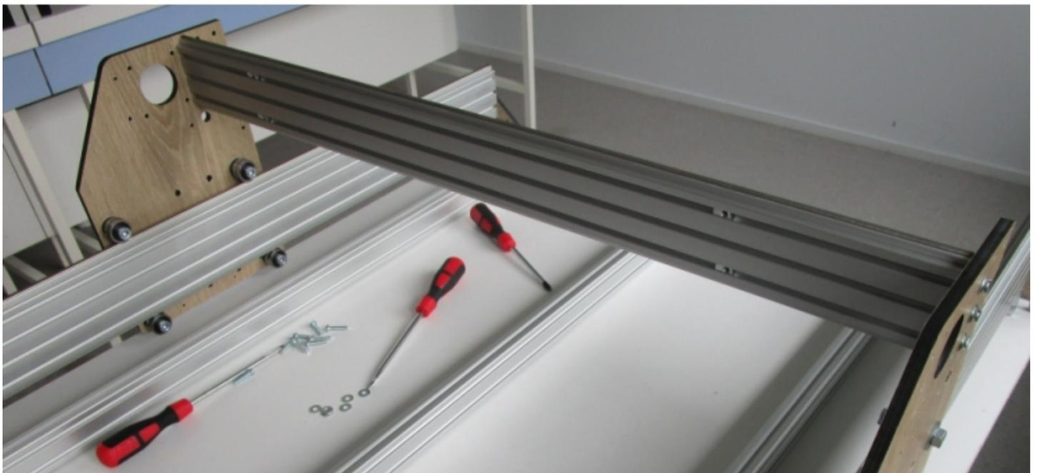
Ensuite, monter le 2ème rail X sur la même plaque de chariot X avec une seule vis et prépositionner également avec une vis sur le chariot Y en vis à vis :
