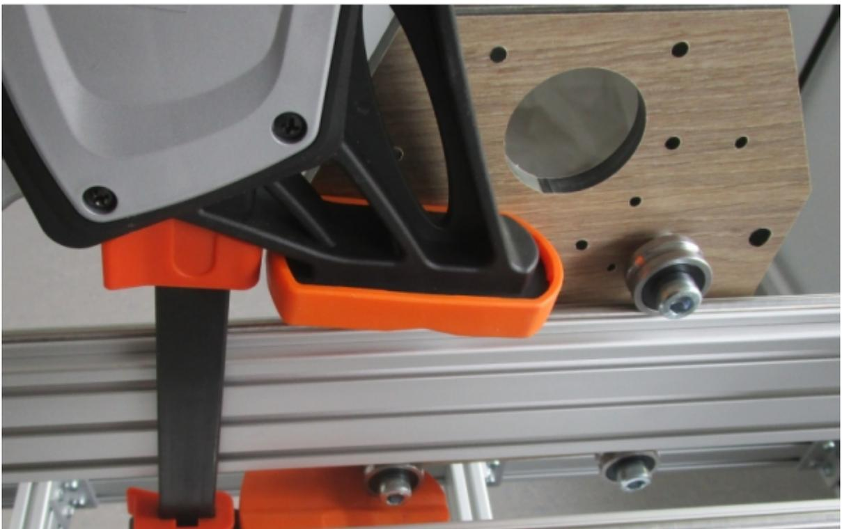
Truc : regarder dans les trous des plaques du chariot Y pour vérifier le bon alignement / engagement des roulements en U sur les barres lisses de guidage :
