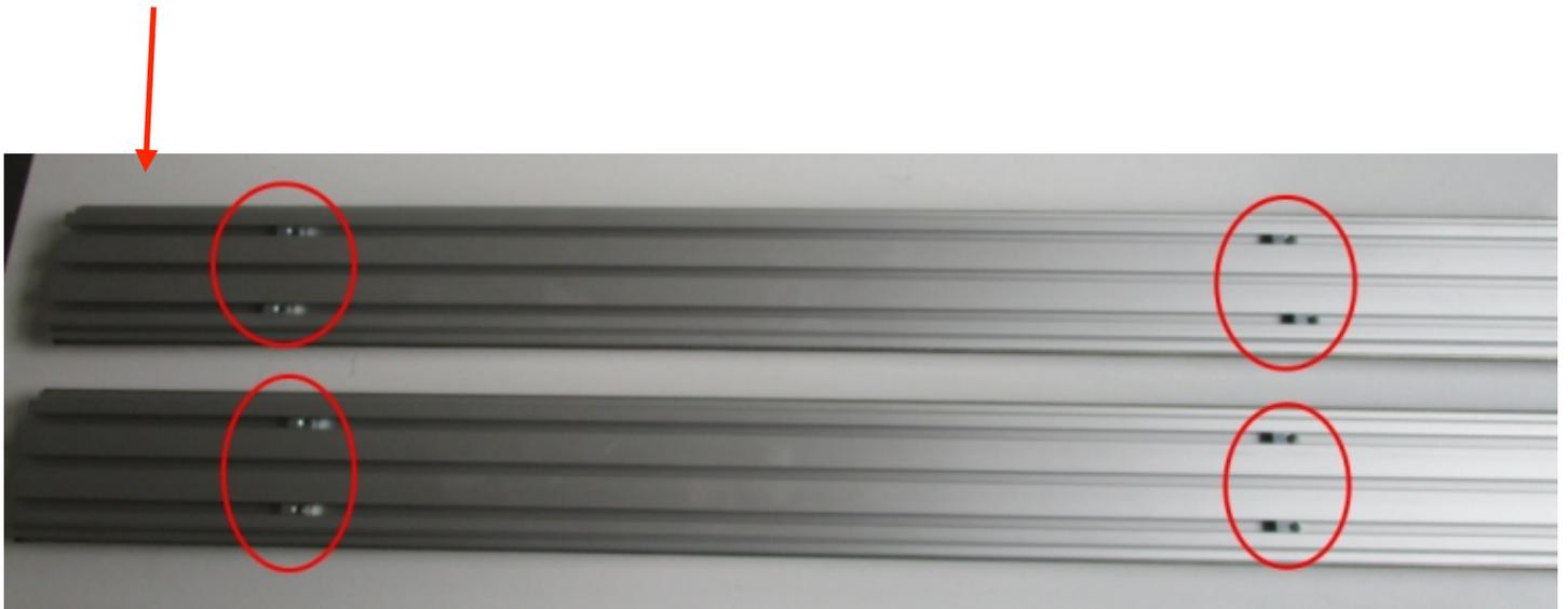
Monter le premier profil à l'aide de 3 vis verticalement sur la plaque de chariot X avec vis M5x20+rondelle :
