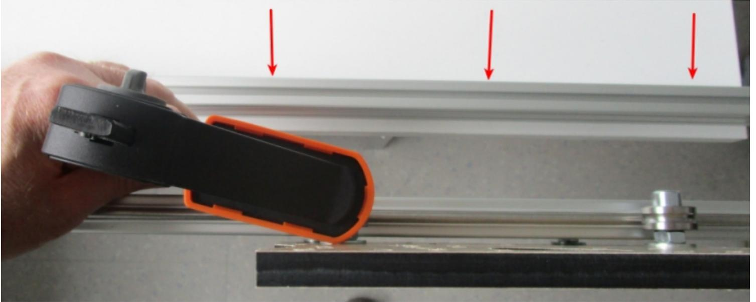
Placer alors un serre-joint prenant 2 roulements en vis-à-vis du haut et du bas et serrer de façon à les ajuster parfaitement au rail.
