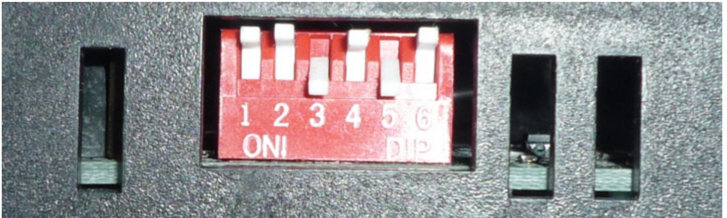
**Sur le Z et même sur Y et X on peut mettre 4A.. soit S4-S5 S6 sur OFF OFF OFF !**
