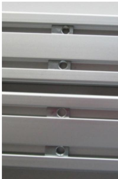
Les prépositionner à **10cm** des extrémités (la face de fixation).
