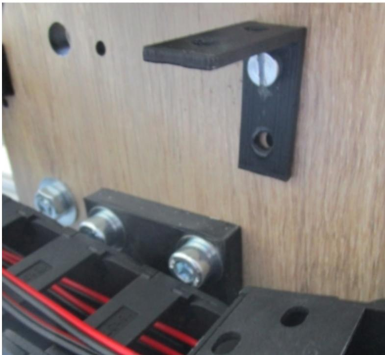
Fixer l'extrémité « moteur » de la chaîne sur l'équerre :
