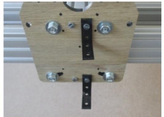
Fixer l'extrémité de la chaîne avec la barette de connexion (côté moteur) sur l'équerre du haut :
