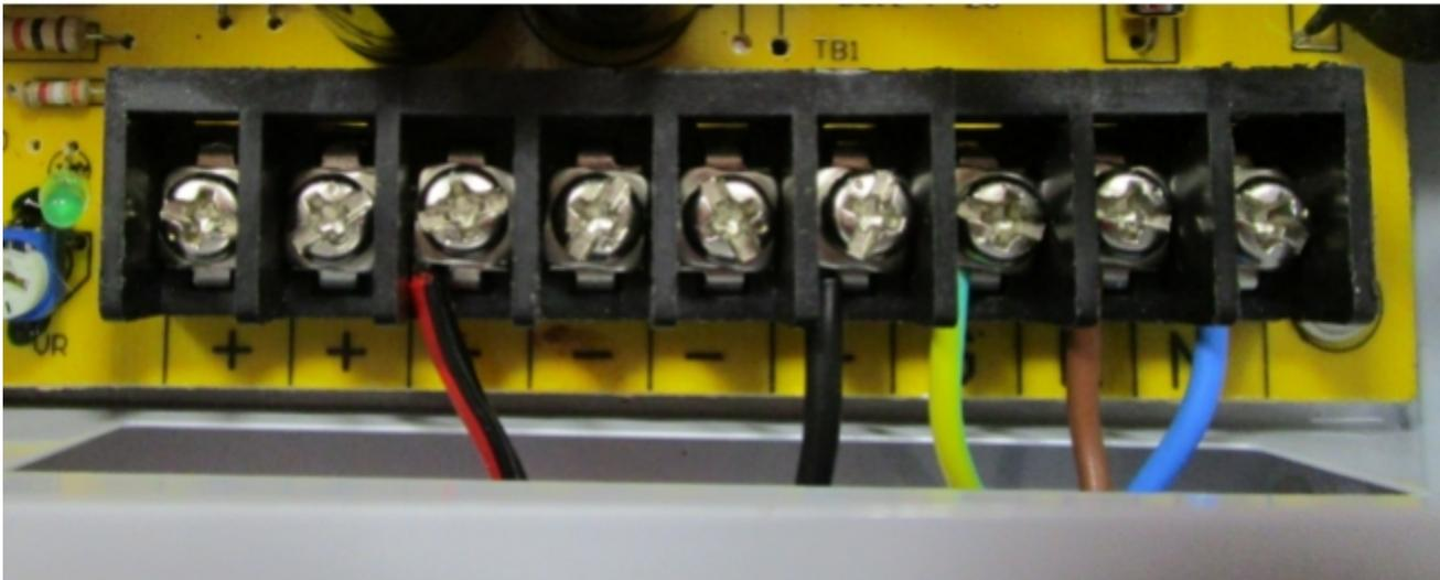
Connecter l'autre extrémité de chaque câble 12V à 2 brins sur le bornier alimentation moteur de chaque étage moteur : bien dévisser les vis du bornier pour pouvoir engager les câbles étamés.
