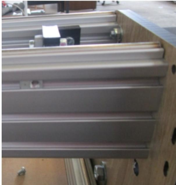
Fixer le endstop sur le support à l'aide des vis M3 en intercalant 2 rondelles M3 entre le endstop et le support.
