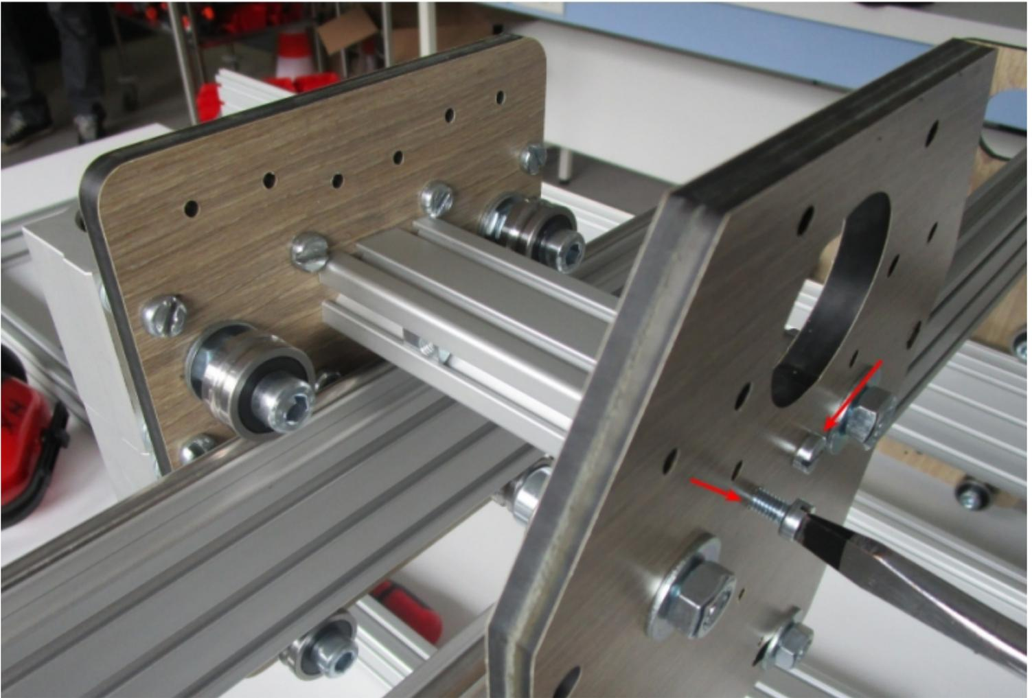
De la même façon, mettre en place le profilé 20x40x110mm du bas :
