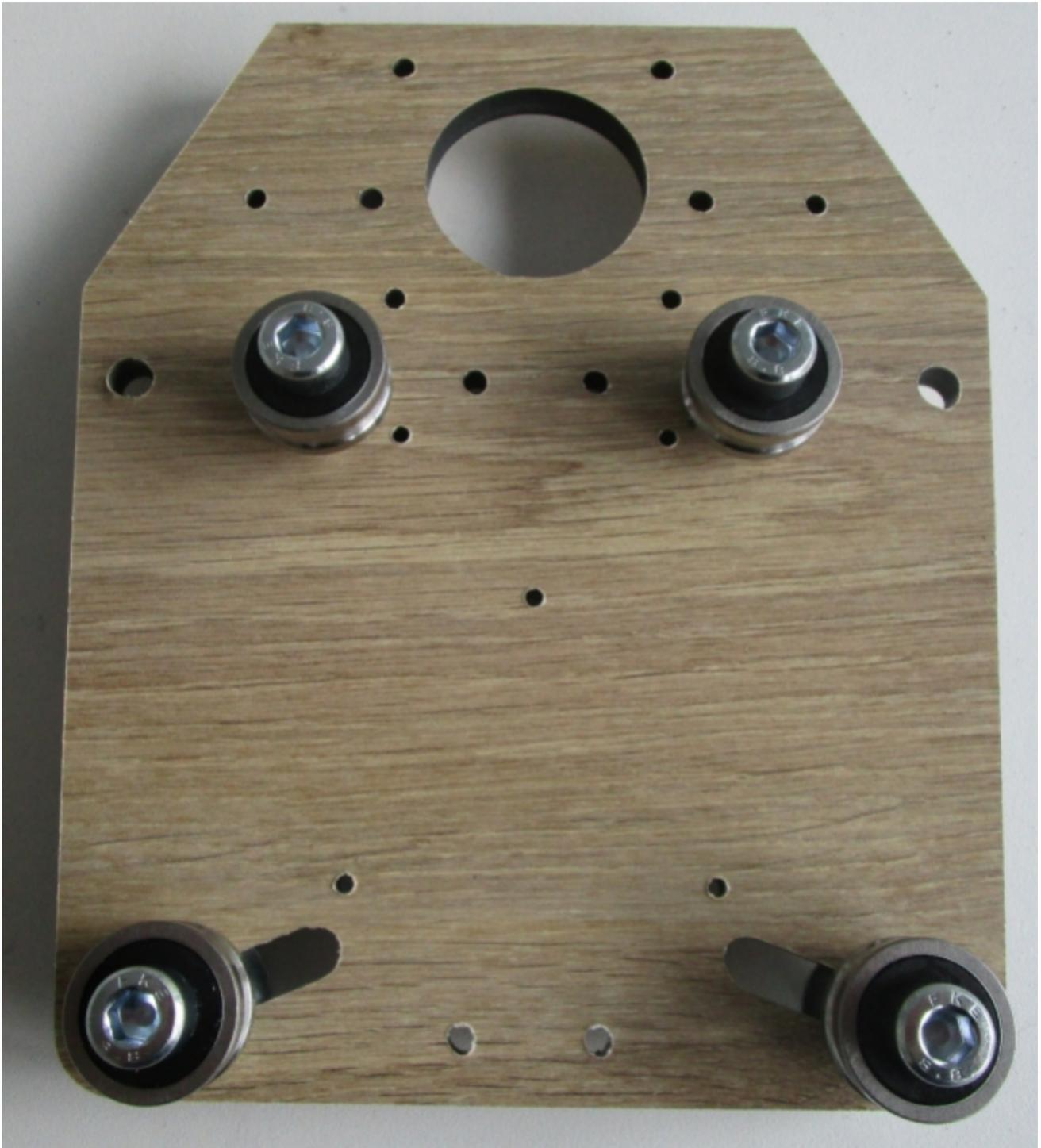
Fixer les roulements du bas avec vis M8 x 35 + écrou + rondelle M8 grande + rondelle M8 grande + écrou :
