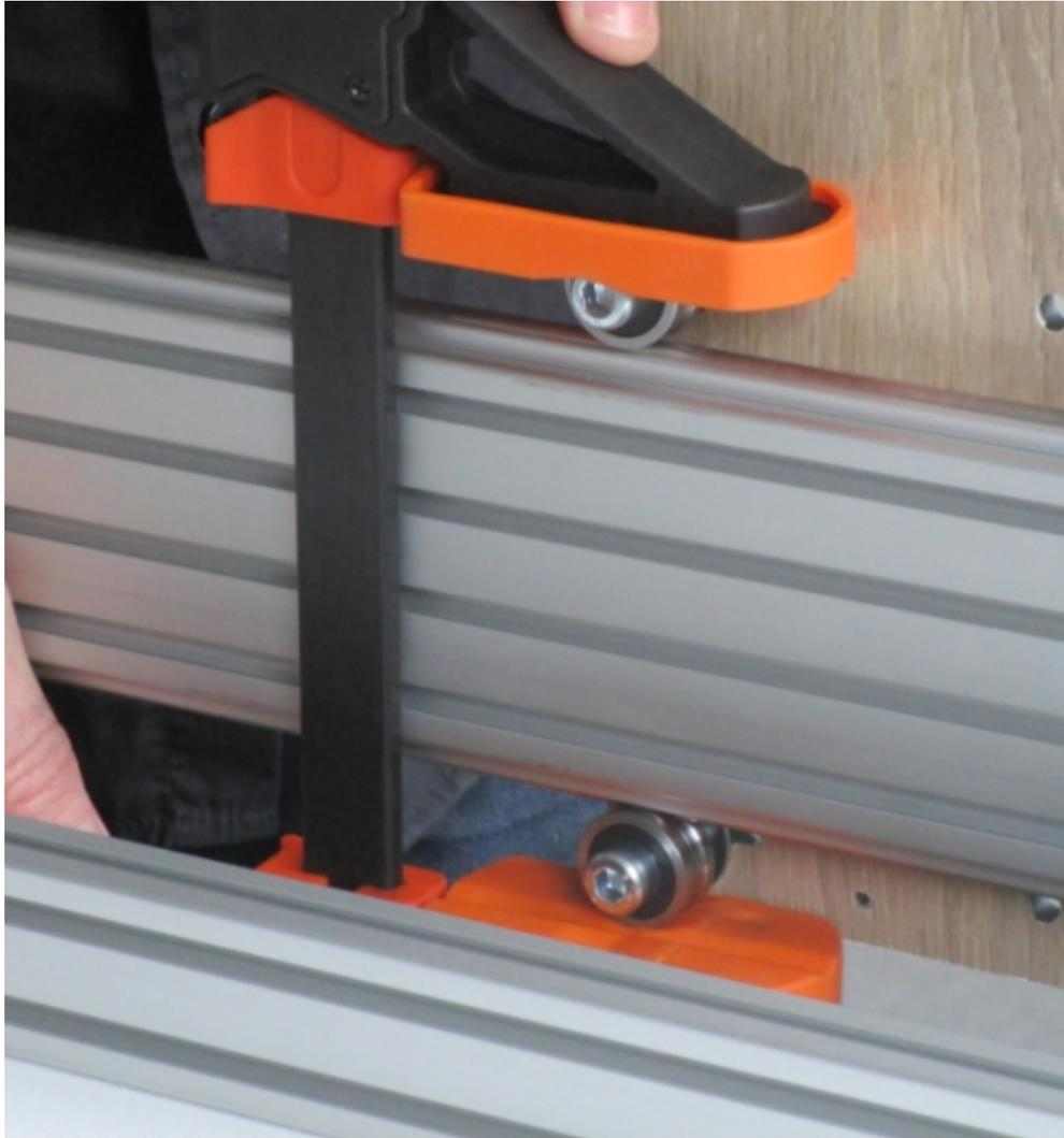
**Alternative : rapprocher les 2 vis du bas avec le serre-joint (mettre les mors du serre-joint en regard d'un plat des écrous).**
