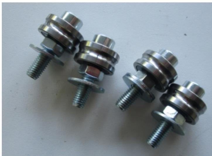
Si on choisit d'utiliser les vis de serrages des roulements du bas, préengager les vis M4x25 (à l'avant) et M4x25 (à l'arrière) dans les trous percés précédemment et visser l'écrou sur la vis sans serrer :
