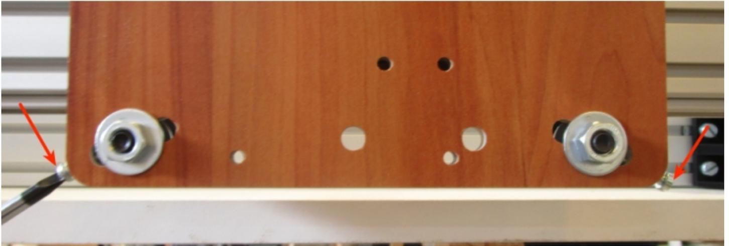
Une fois les vis de serrage serrées (on doit obtenir une translation fluide avec une légère contrainte), serrer les écrous des vis de fixation des roulements eux-mêmes.
