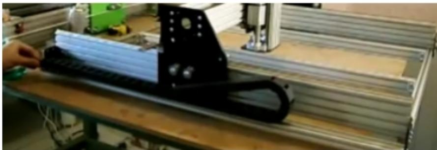
Fixer la chaîne au chariot à l'aide d'un plat 20x80 fixé sur une équerre :
