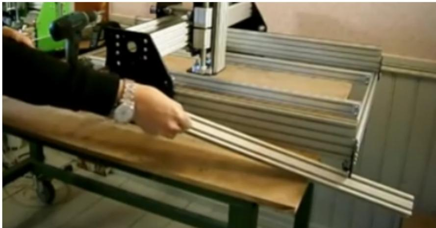
Mettre en place le profilé 20 x 40x970 de support de la chaîne passe câble :
